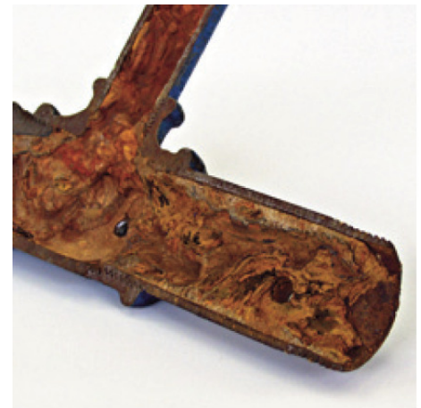
Maßnahmen bei verzinkten Stahlleitungen
